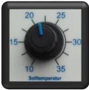
Mit dem Drehknopf wird die Solltemperatur eingestellt
